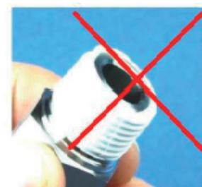
注意密封带缠绕方法，可以避免密封带脱落后吸入泵体
